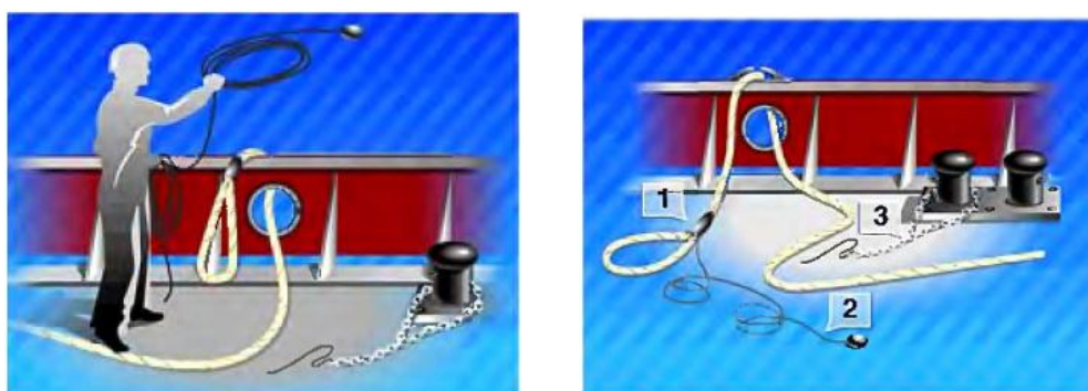
Рис.2 Расположение швартова на баке перед отдачей
