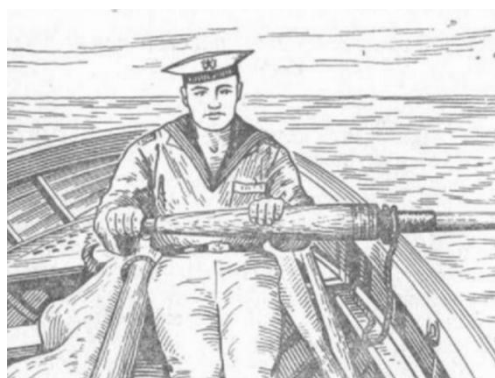
Рис. 2. Исходное положение для гребли (лопасть развернута параллельно поверхности воды)
