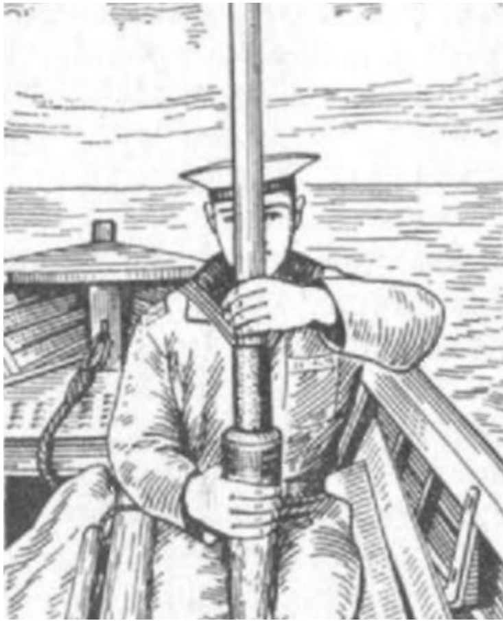
Рис. 6. Положение по команде «Весла на валец» (лопасть развернута параллельно диаметральной плоскости шлюпки)
