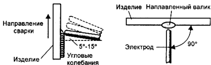
Рис. 1. Положение электрода при наплавке узких валиков без поперечных колебаний электрода в вертикальном положении снизу вверх
