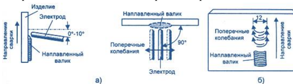
Рис. 3. Положение электрода при наплавке валиков в вертикальном положении снизу вверх с поперечными колебаниями электрода (а) и траектория движения электрода (б).
