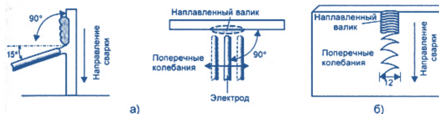
Рис. 4. Положение электрода при наплавке валиков в вертикальном положении сверху вниз с поперечными колебаниями электрода (а) и траектория движения электрода (б)
