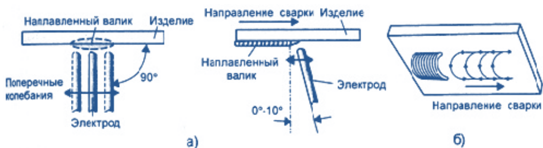
Рис. 6. Положение электрода при наплавке валиков с поперечными колебаниями электрода в потолочном положении (а) и траектория перемещения электрода (б)
